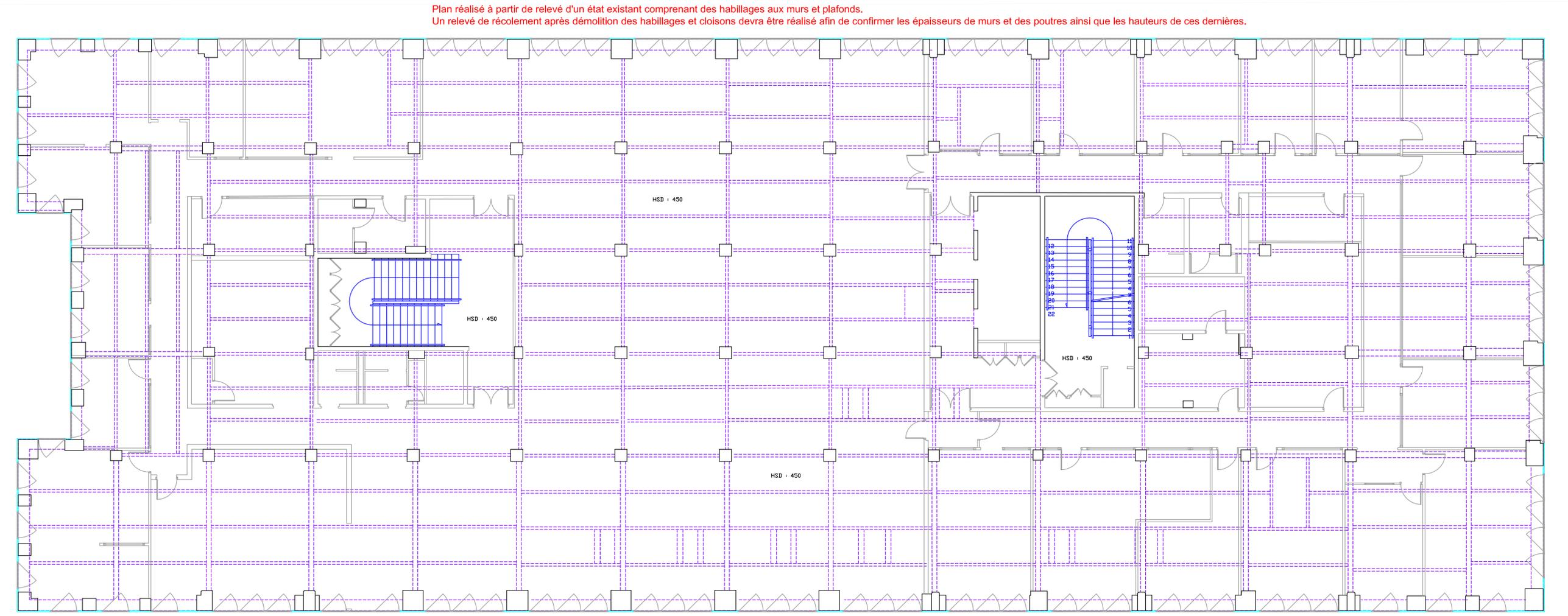
**Plan réalisé à partir de relevé d'un état existant comprenant des habillages aux murs et plafonds. Un relevé de récolement après démolition des habillages et cloisons devra être réalisé afin de confirmer les épaisseurs de murs et des poutres ainsi que les hauteurs de ces dernières.**
