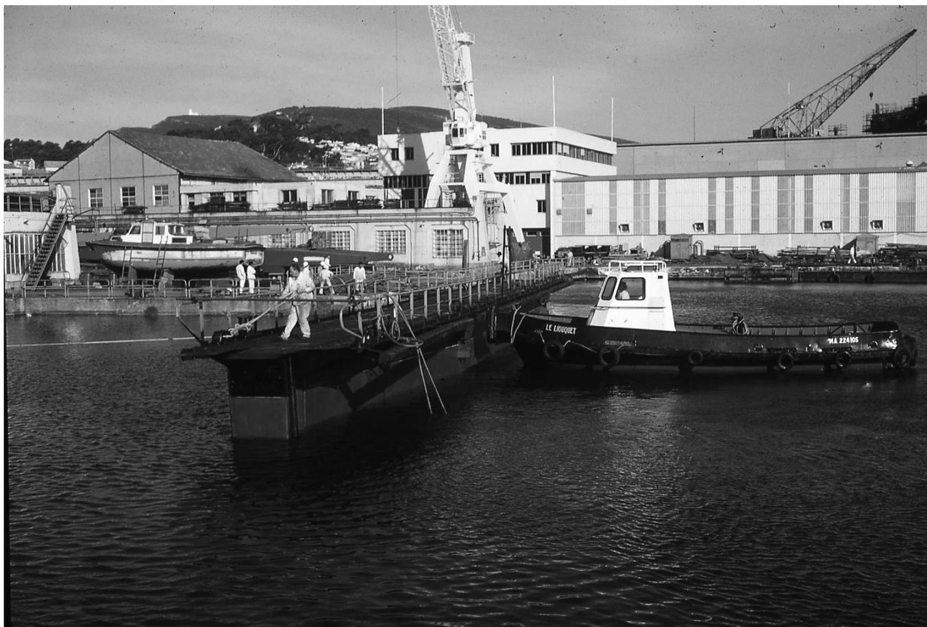
Figure 4 : Flottaison du bateau porte, un remorqueur le pousse afin de le déplacer.
