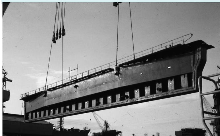
Le contact avec les bords de cales permet de gérer l'étanchéité, qui est quasi parfaite. Cette étanchéité est assurée par des éléments en cordage, chêne, chanvre ...
